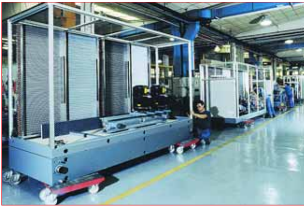
■ Завод RC GROUP в Милане. Сборка чиллеров
