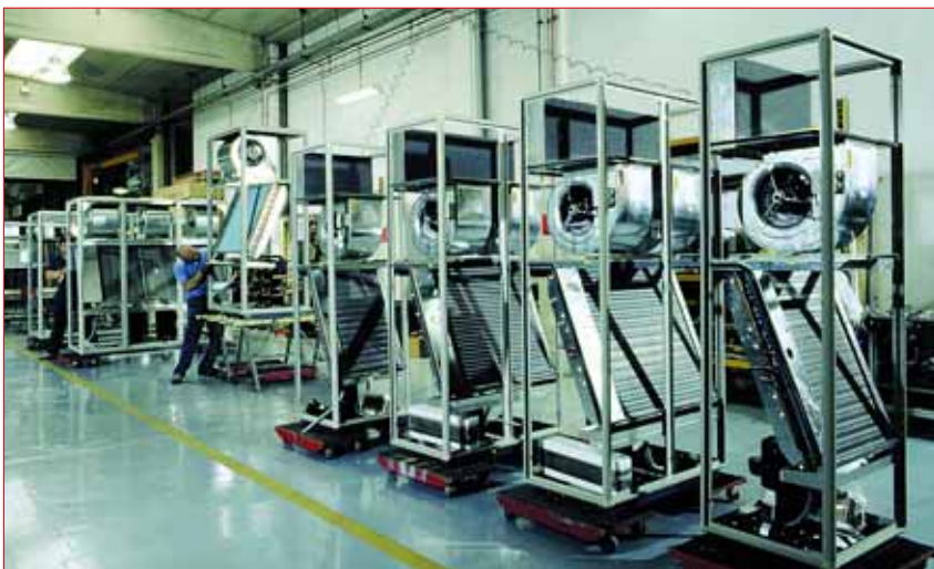
■ Цех сборки прецизионных кондиционеров
