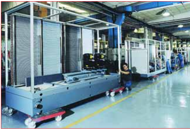
■ Завод RC GROUP в Милане. Сборка чиллеров
